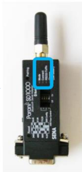
《Bluetooth PARANI》 配線が固定され、2番目・3番目 のランプが点滅【OK】
